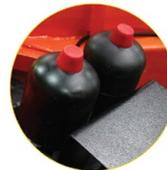
**Hydroakkumulator** – Druckspeicher der Pulsationen im Hydraulikkreis dämpfen lässt ( Schutz des Hydraulikzylinder vor Beschädigung, die vom großen Druck des Strichblechs verusacht wird.
