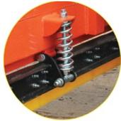
**Die Stoßdämpfung der Pflugschar** – Der Stoß in Pflugschar ist durch die Triebfeder verbundene mit abstreckene Kaste amortisiert, Federmange 4 Stück, Druckregelung Möglichkeit.
