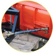
**Spannschraube** – Basisversion des Schneepfluges sind in Spannschraube anstatt, die zu Verrenkungswinkel Schneepfluge dienen.
