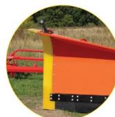
**Seitliche Polyurethangehäuse** – Gehäuse Set an seitlichen Kanten des Pflugschares befestigt. Die Gehäuse sichern Randabwieser ( das gilt auch Pflugschar von Stahl HB 500 hergestellt ). Die Polyurethangehäuse verbessern auch Schnee räumen, der Schneepflug vermindert sich die Rückhaltekraft, gleitet noch leichter über die Kanaldecken oder Randsteine, die den Schneepflug beschädigt werden können.
