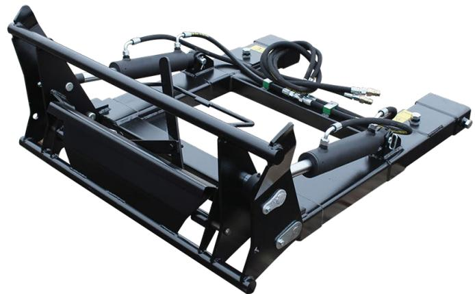
Mit dem Stapler Schnell Wechsel Rahmen können sämtliche Anbaugärete mit Euroaufnahme verwenden. Zinken von Gabelstapler passen zu Taschen von Schnellwechsler und sind gut bäfestig. Bei Konstruktion sind die hydraulik Zylinder und Leitungen mit zweifacher Sicherung von Firma Waryński verwendet. Alle bewegliche Teile sind mit Schmiernipel geeignet.
