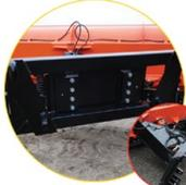
**Kopierfunktion des Geländes** – der sogenannt Funktion „schwimmende Rahme“, die bewegen sich oben/unten und rechts/links, Schneepflug anpasst.
